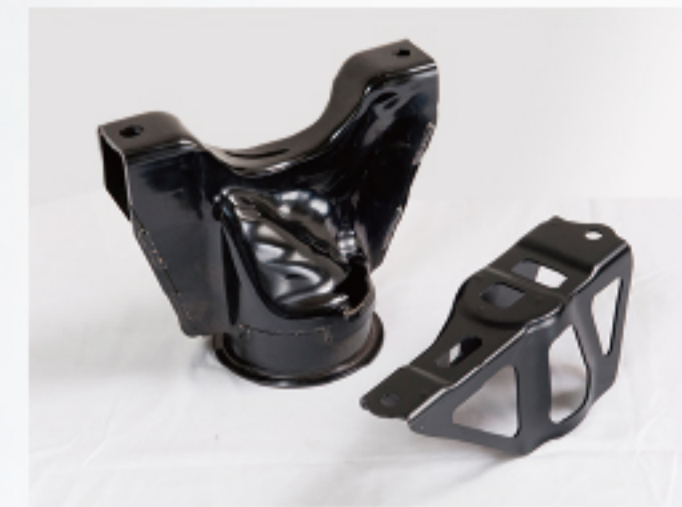
自動車用エンジンマウント試作品 [SAPH440 T=2.0~3.2mm]
